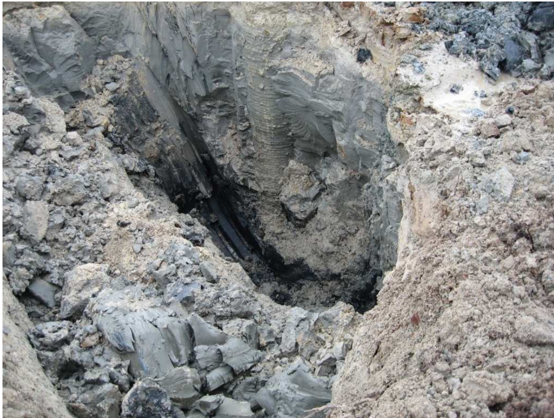
Figur 4-10. Pelare E9 nedschaktad fram till djup 2-3 m, pelarstrukturen syns tydligt.
