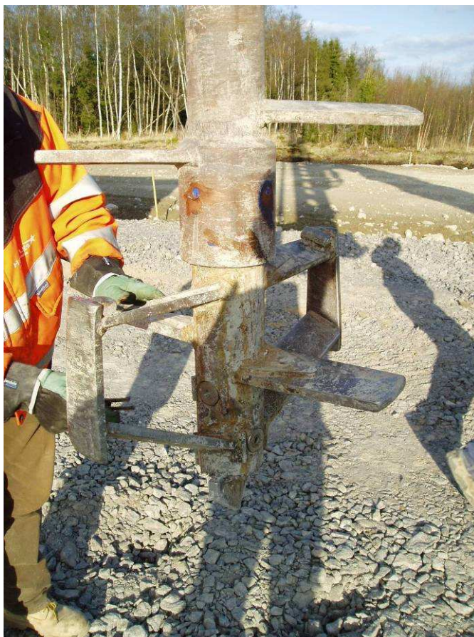
Figur 4-6. Närbild av redskap för inblandning, ”MDM - bygel”
