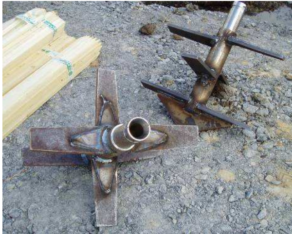
Figur 4-5. Närbild av redskap för inblandning, ”Pinnborr”
