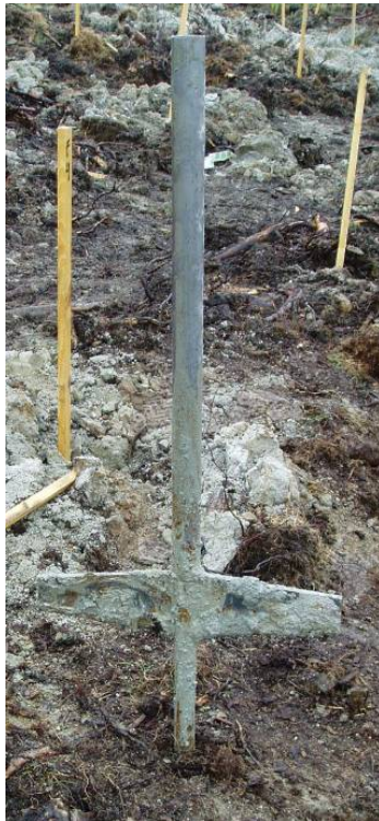
Figur 4-9. Närbild av pelarsond (500x15 mm), som användes för kontroll av pelarens hållfasthet.
